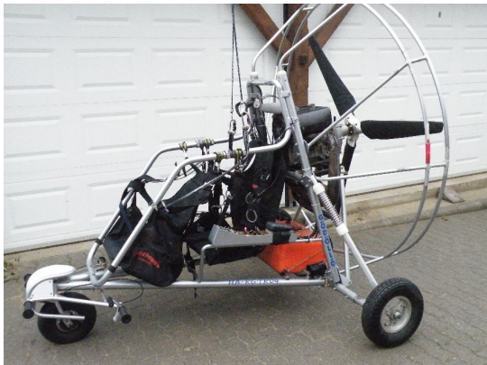
17. ábra. Rotax 503 segédmotorral szerelt PPG Trike
